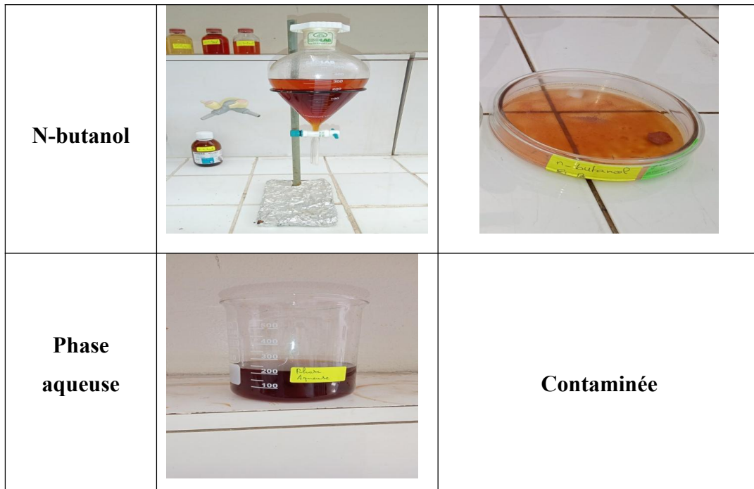
Fig. 24 Fractionnement de l'extrait méthanolique en phase liquide- liquide.
